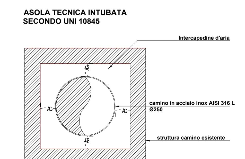
Pianta schematica asola tecnica
